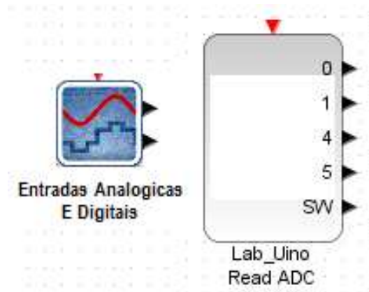
Figura 4 - Símbolo de inserção e diagrama entradas analógicas e digitais
