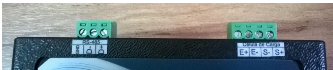
Figura 7A – Conexões Comunicação e Célula de Carga do CP-WS42/32K-4DO4DI1AO-CEL CARGA
