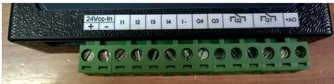
Figura 7B – Conexões saídas e entradas do CP-WS42/32K-4DO4DI1AO-CEL CARGA
